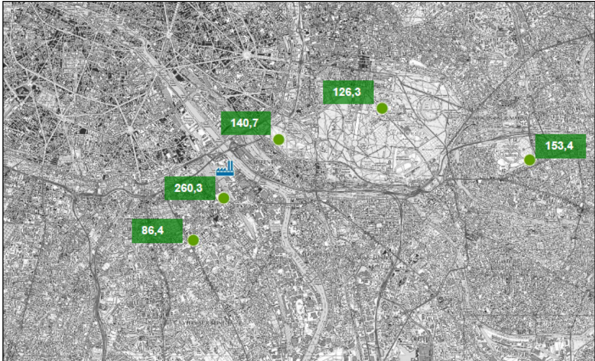
Carte des dépôts en métaux en mg/kg de matière sèche dans les lichens observés lors de la campagne 2014
