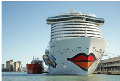
Bunkering de AFs
