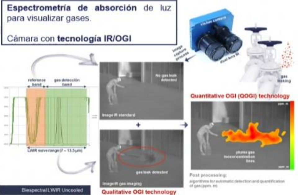
Detección emisiones fugitivas
